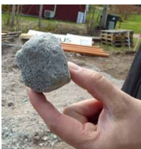
Huset byggs till stora delar av ekologiskt och återvunnet material, bland annat skumglas.
